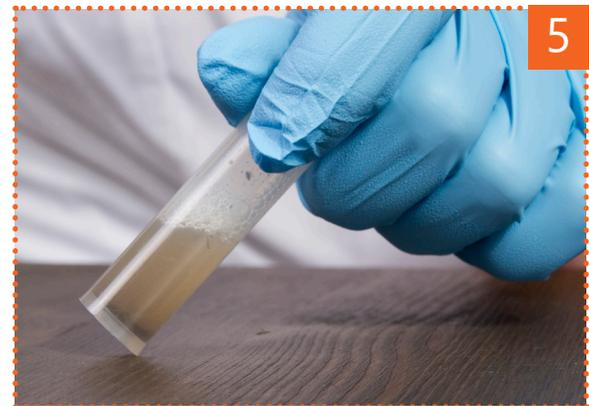
■ Tapoter le tube échantillon sur une surface dure pour que tout le liquide se collecte dans le fond du tube.
